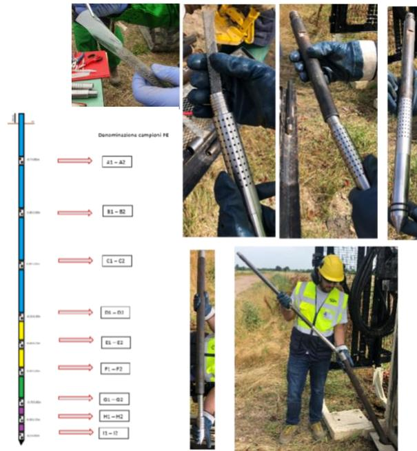
Figura 8-11: Campionatore passivo per monitoraggio in profondità
