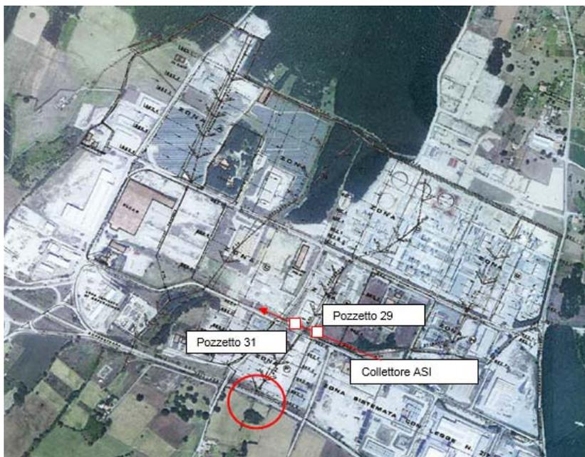
*Figura 14 Planimetria con ubicazione dei drenaggi degli impluvi naturali e del collettore ASI ispezionato tra i pozzetti 29 e 31. Nel cerchio rosso è individuata l'area dell'attraversamento della SS598*
