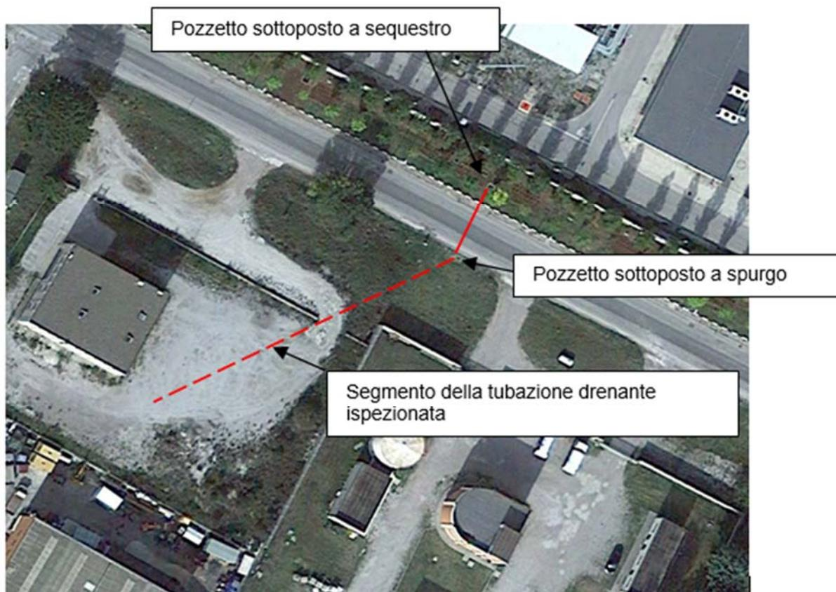
*Figura 12 indicazione del segmento di tubo drenante video ispezionato*
