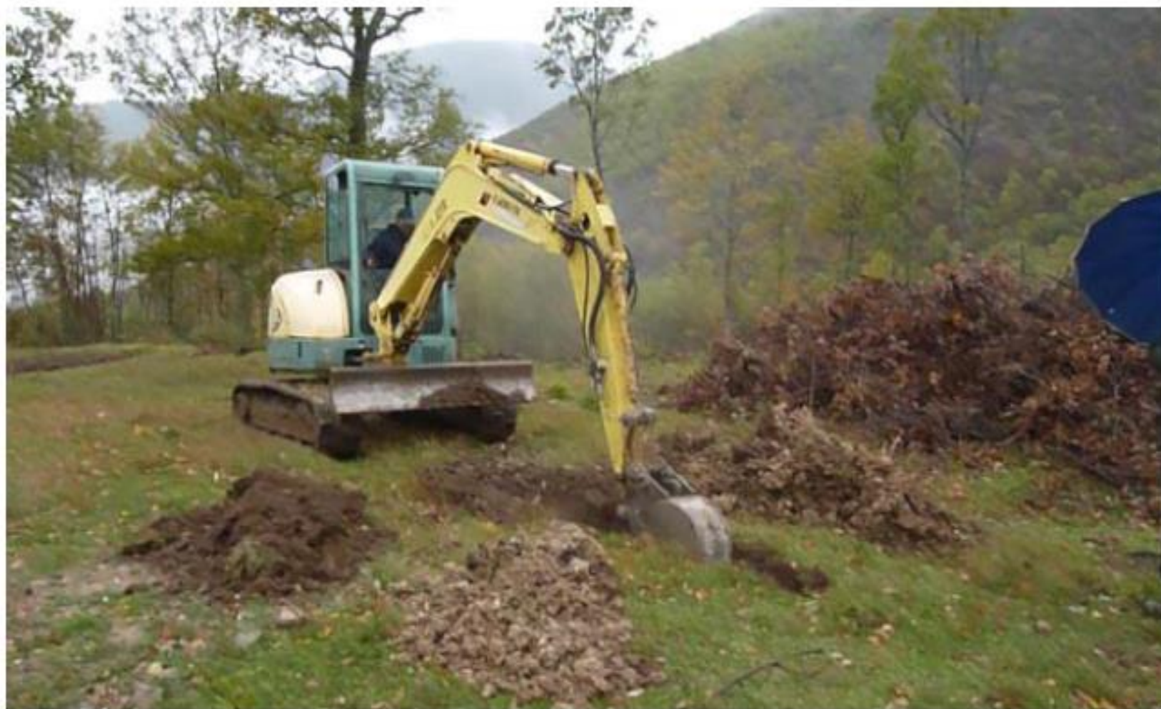
Figura 5. – La macchina impiegata per il campionamento: di fronte alla lama il cumulo, piccolo, del terreno di superficie; a ore 8 il primo metro; a ore 7 il secondo.
