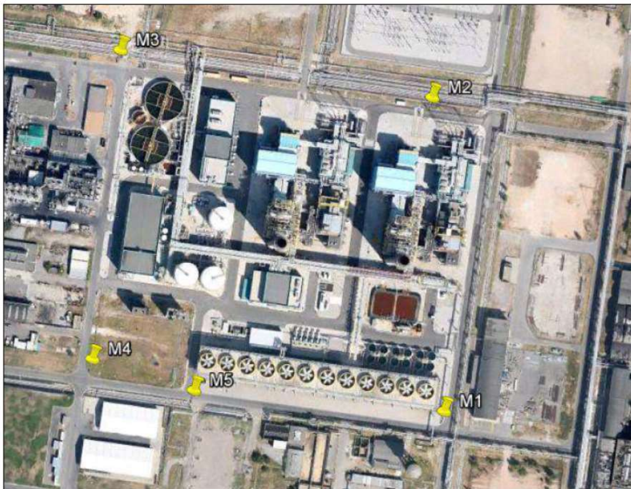
Figura 21 - Ubicazione dei punti di rilievo di immissione sonora (Nord in alto, 1 cm = 20 m)
