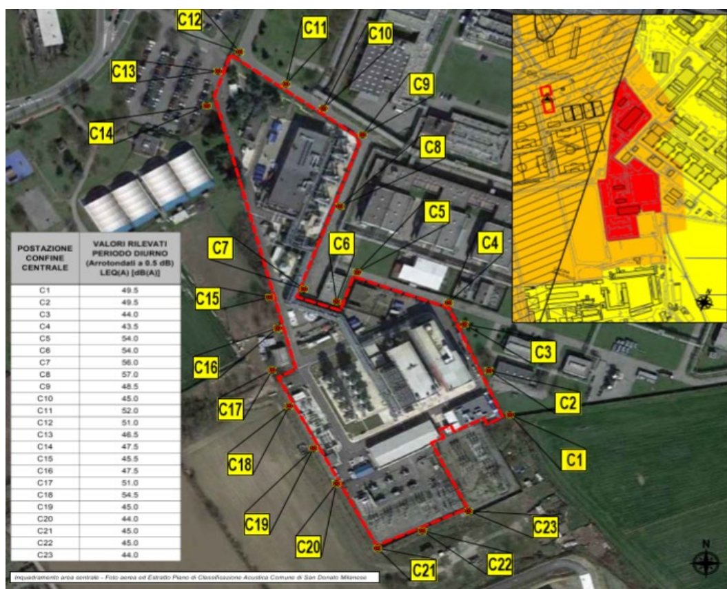
Figura 19 – Posizione delle postazioni a confine della centrale
