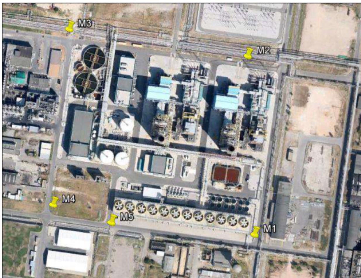
*Figura 15 - Ubicazione dei punti di rilievo di immissione sonora (Nord in alto, 1 cm = 20 m)*
