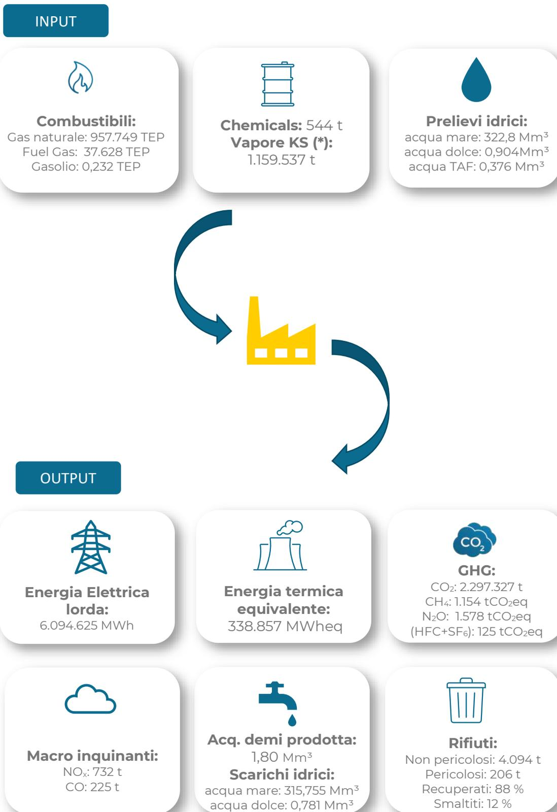
(\*) Il vapore KS è prodotto nelle convettive dei forni dell'impianto cracking di Versalis (130 bar - 520°C) e utilizzato nelle turbine a vapore di Enipower per la produzione di Energia Elettrica
