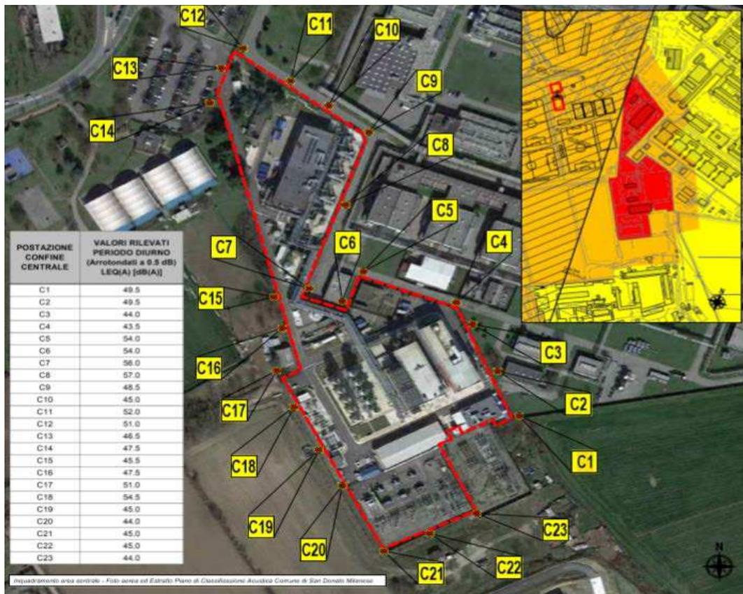
Figura 19 – Posizione delle postazioni a confine della centrale
