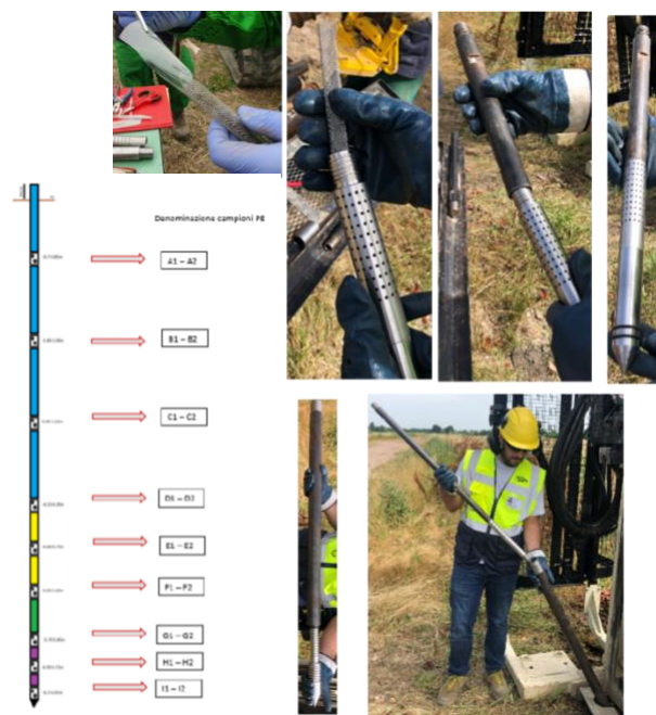
Figura 8-11: Campionatore passivo per monitoraggio in profondità – sistema di rivestimento e applicazione mediante peoprobe
