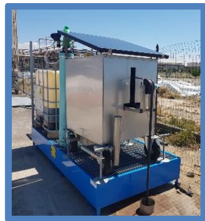
Figura 8-2: Il dispositivo e-hyrec® posizionato in falda. È costituito dalla parte calata in pozzo e dal sistema di movimentazione, gestione e controllo posto a bocca pozzo.
