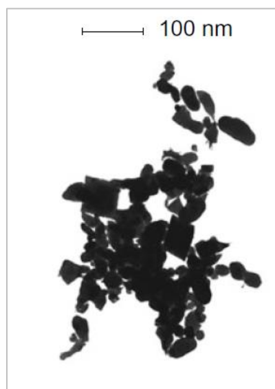
Figura 7-1 : Immagine SEM di particelle di ferro zerovalente nanometriche.
