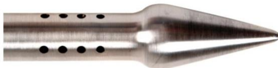
Figura 8-9: Sonda in acciaio inossidabile al cui interno viene posizionato il film di polietilene per l'installazione in campo tramite tecniche a infissione diretta (direct push)
