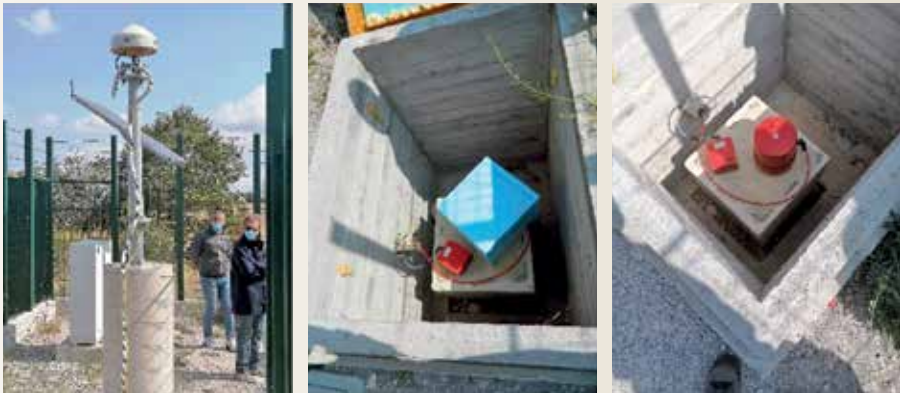
Fig. 3: Foto della stazione multi-parametrica Armento di ultima generazione, con alimentazione a pannelli solari e batterie. La stazione è composta da GPS (basso a sx), sismografo a breve periodo (cilindro rosso) e accelerometro cubo rosso, installato su un plinto di cemento scollegato dalle pareti dello scantinato. Per garantire un ottimo isolamento termico, entrambi i sensori sismici sono installati all'interno di un pozzetto di cemento armato e vengono poi coperti da polistirolo (da Danesi et al., 2020).
